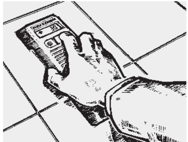
Einfaches Nivellieren durch Ein-Tasten-Bedienung (typischer Einsatz des Handgerätes)
